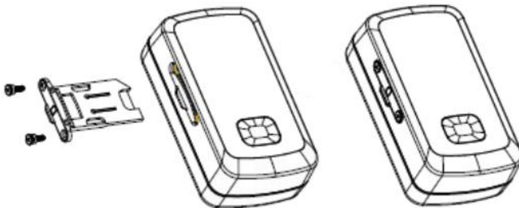
Для установки SIM-карты открутите прилагаемой отверткой два болта на крышке слота SIM карты. Установите SIM карту в слот и снова закройте крышкой.
